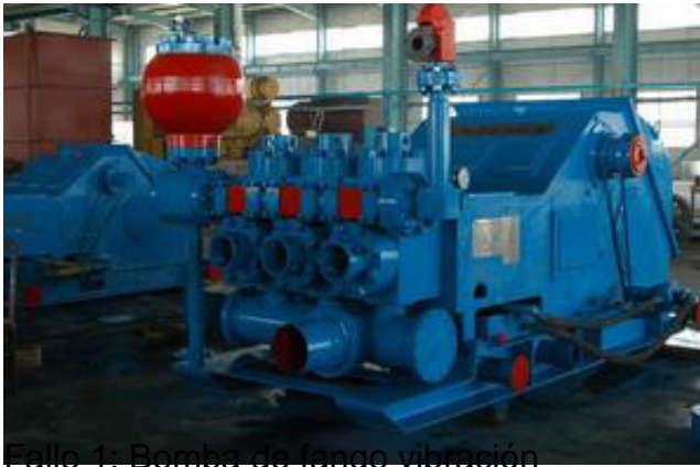
Fallo 1: Bomba de fango vibración
